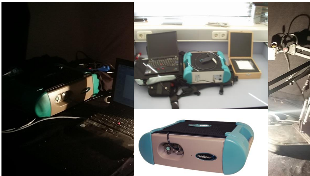
شکل ۲- دستگاه اسپکترورادایومتر FieldSpec و نحوه قرارگیری آن در آزمایشگاه.
