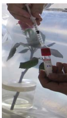
شکل ۳- نحوه نمونه‌گیری اتیلن پس از ۲ ساعت و انتقال به ونوجکت‌های خلأ، به‌ترتیب مراحل انجام شده (الف، ب و ج)
